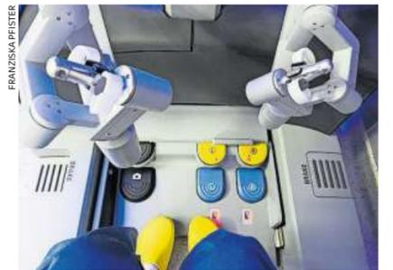
Die Konsole des Roboters mit Steuerknüppeln und Pedalen. (Basel, 12. April 2022)
